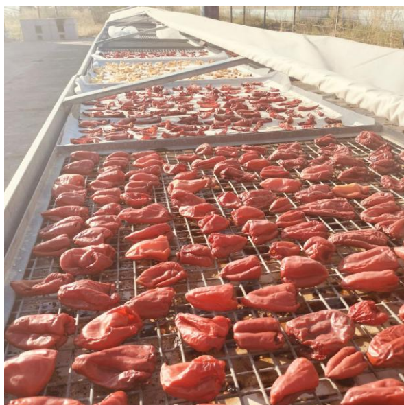
1-rasm. Shirin qalampirni quritish uskunasi quritish jarayoni
