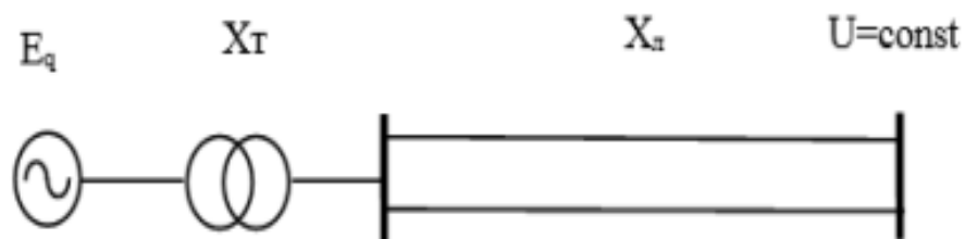
3-rasm Oddiy elektr tizimning prinsipial sxemasi
