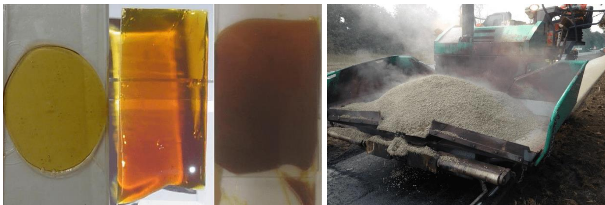
2-rasm. a) shaffof sintetik bog'lovchi va b) u asosidagi rangli asfalt -beton qorishmasi [2].
